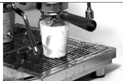
Vorsicht! Bei einem Leerbezug (Flush) mit eingespanntem Filterträger besteht **Verletzungsgefahr**. Das heiße Wasser sprudelt aus dem Filterträger.
